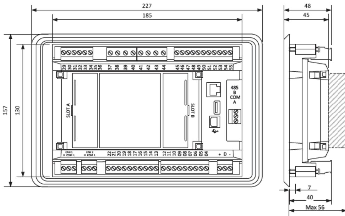
**Note:** L'épaisseur totale occupée par le contrôleur dépend des modules d'extensions sélectionnés - Elle peut varier de 41 à 56 mm. Prendre en compte également la taille des connecteurs et câbles (ex. dans le cas d'un connecteur RS232 ajouter en plus 60 mm pour un connecteur de base RS232 plus le câble).
